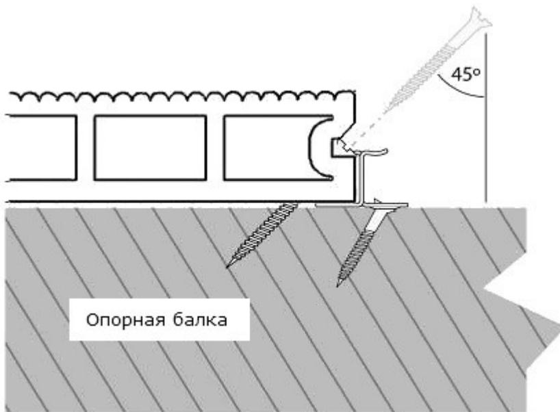
При креплении шурупов ближе, чем 30мм от края доски, мы советуем предварительно просверлить отверстия, чтобы доска не раскололась. При монтаже террасной доски, необходимо учитывать температурное расширение материала, и всегда оставлять зазор между ограждающей конструкцией и материалом не менее 30мм.
