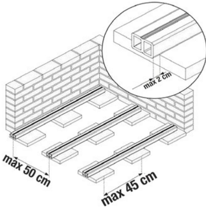
Основание должно быть достаточно плотным — щебень, гравий, бетон и т.п. При укладке на грунт, необходимо произвести его выемку, затем отсыпать основание щебнем, вибрационно уплотнить его, после чего насыпать постель из гравия толщиной 50мм. При подготовке основания, нужно предусмотреть уклон не менее 5мм в направлении вдоль укладываемой террасной доски. Далее, в качестве опор для балок укладываются бетонные плиты размером 300\*300\*50мм.
