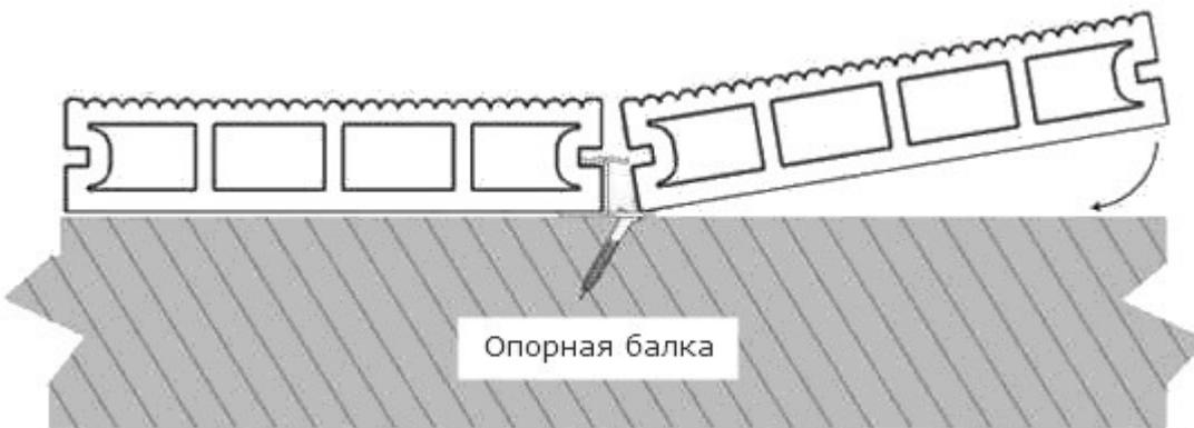
Вставьте монтажный кронштейн так, чтобы он плотно прилегал к выступу доски, при этом отверстие для шурупа в зажиме должно совпадать с осью опорной балки. Плотно прижимая зажим к доске, закрутите шуруп в отверстие зажима под углом 30°. Закрепите по одному зажиму к каждой опорной балке. Вставьте следующую доску
